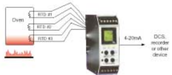
SPT 为现场可编程、通用的温度变送器
